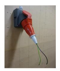
Подготовленные разъёмы соединяется с соответствующими разъёмами ЭУ. К полученным проводникам подключаются электроды мегомметра. Напряжение – 250, 500В.
